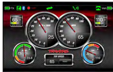
Le tableau de bord personnalisable de Traxxas Link affiche en temps réel les rpm, la vitesse, la température et la tension.
